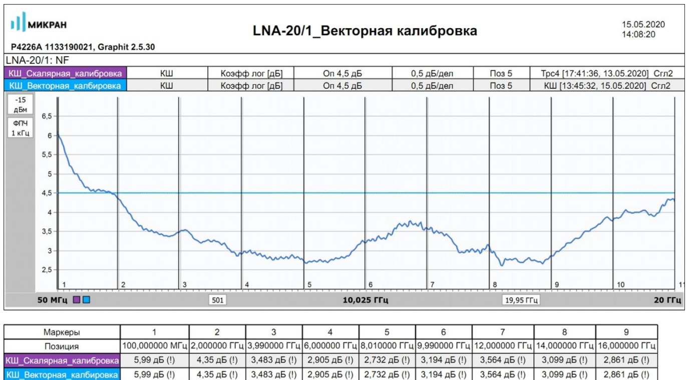
Рис. 11. Результаты измерения коэффициента шума «LNA20/1» со скалярной калибровкой
